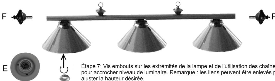
Étape 7: Vis embouts sur les extrémités de la lampe et de l'utilisation des chaînes pour accrocher niveau de luminaire. Remarque : les liens peuvent être enlevés pour ajuster la hauteur désirée.
