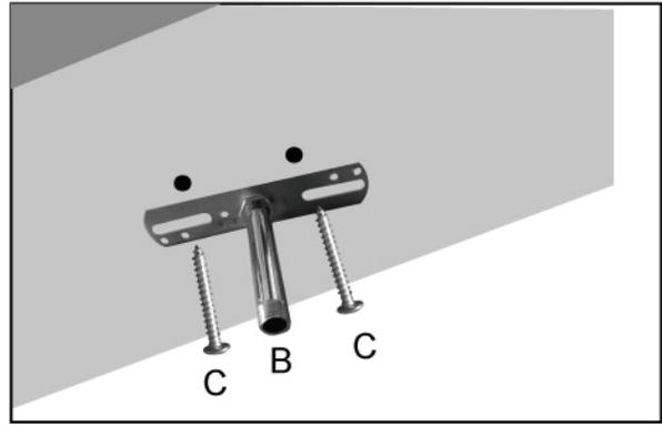
Étape 2: Un support sera visser au plafond. \* Remarque : au moins un support va monter à une boîte électrique existant ou installé pour fournir de l'énergie. S'il vous plaît tenir compte lorsque sélection de l'emplacement.
