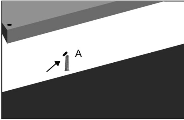
Étape 1: Déterminer la position de lumière se bloque et marquer les emplacements sur des chaînes de montage plafond afin pendent droite. Essayez de frapper une solive du plafond. Sinon, utilisez le support comme gabarit, marquer et percer les trous pour les ancrages en plastique.
