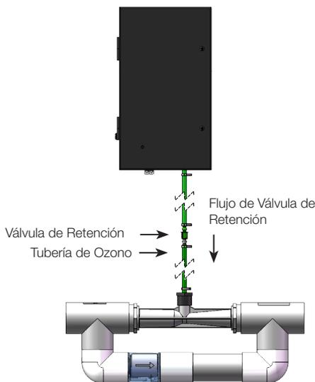
**Figura 3b: Montaje de Tubería de Ozono**
