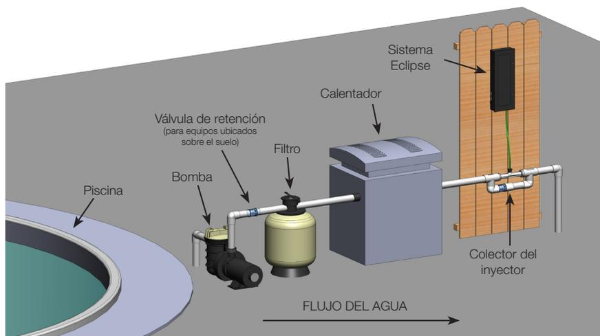
**Figure 2: Ubicación de Montaje del Colector del Inyector**
