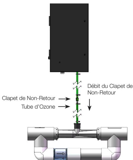
**Figure 3b: Assemblage du Tube d'Ozone**
