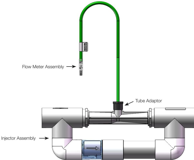
**Figure 3a: Flow Meter Assembly**
