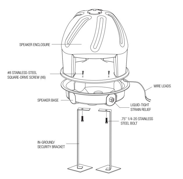
[BOX CONTENTS] 1 IN-GROUND SPEAKER 1 ANTI-THEFT DEVICE (2 PEICES) 1 LIQUID-TIGHT COMPRESSION FITTING 1 SQUARE DRIVE BIT 2 WIRE NUTS 6 #8 STAINLESS-STEEL SQUARE-DRIVE SCREWS 2 .75" 1/4-20 STAINLESS STEEL BOLTS
